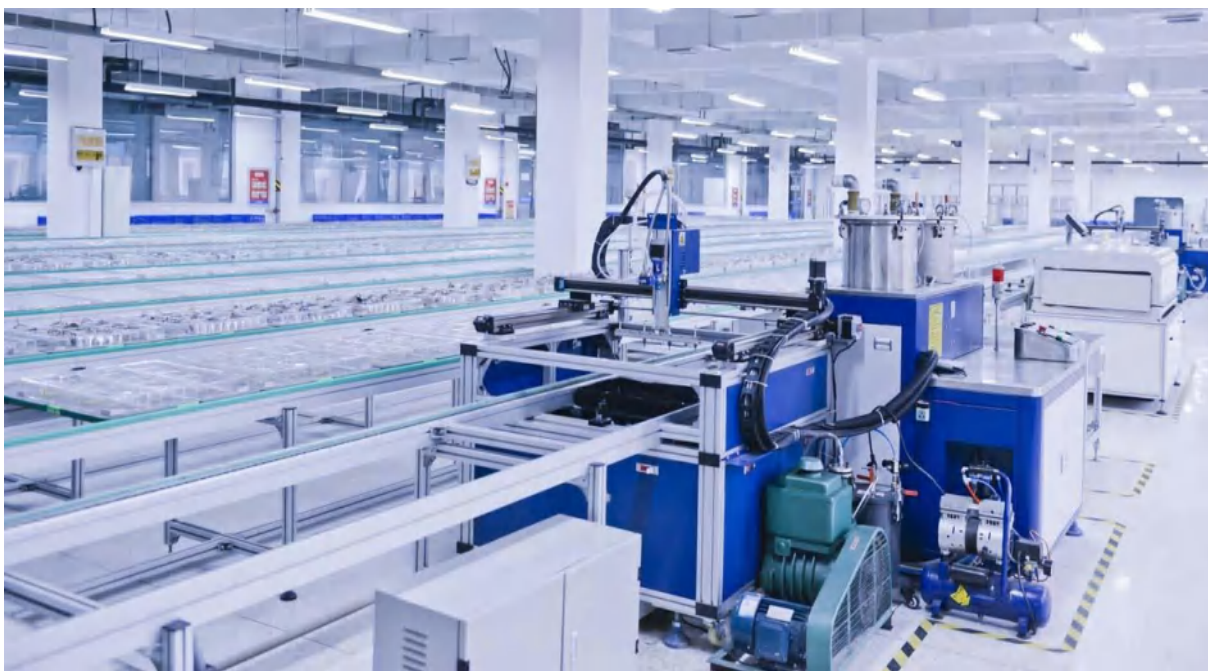
全自动智能灌封系统（智能水表行业国内最大）
