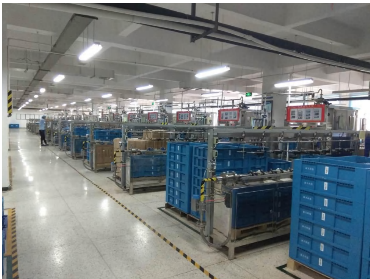
水表智能化检定车间
