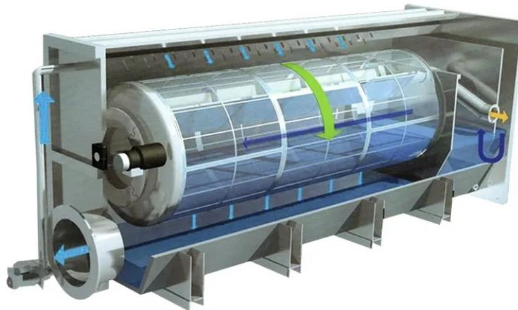
图5.7-16 精密过滤工作原理示意图
