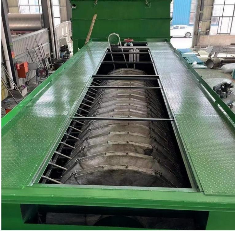
图5.7-17 纤维转盘滤池实体图
