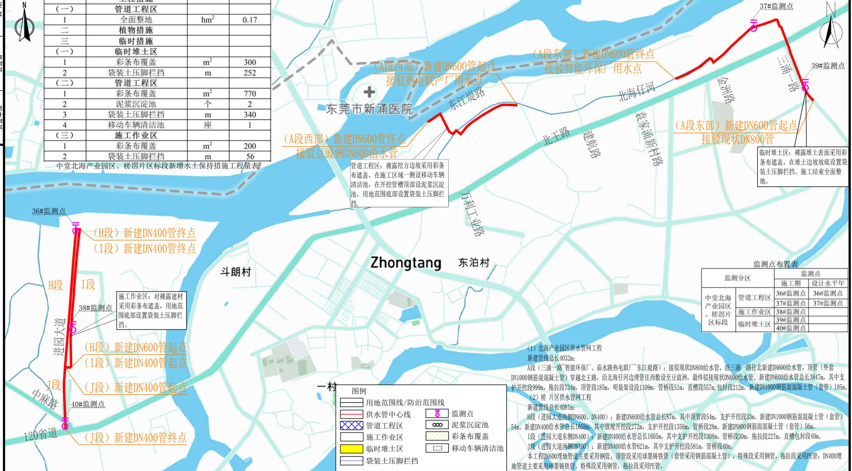
管道工程区：裸露土方边坡采用彩条布遮盖，在施工区域一侧设移动车辆清洁池，在开挖管槽顶部设泥浆沉淀池，用地范围底部设置袋装土压脚拦挡。
