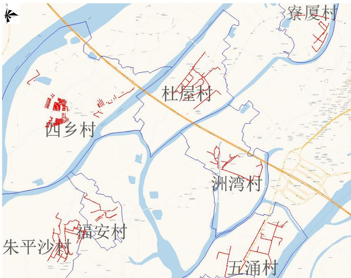
图 2.1-7 望牛墩镇供水管道改造方案图
