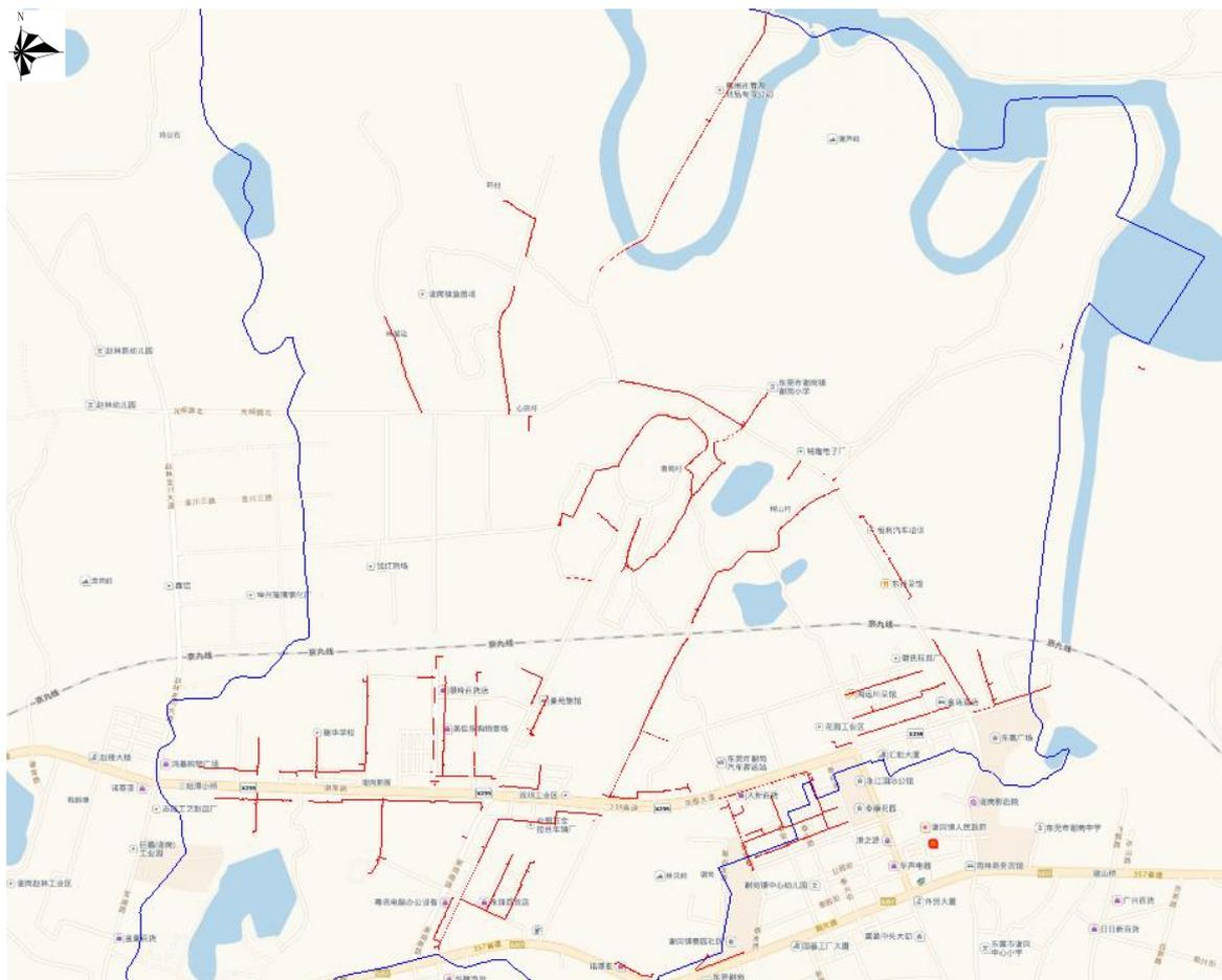
图 2.1-4 谢岗镇供水管道改造方案图
