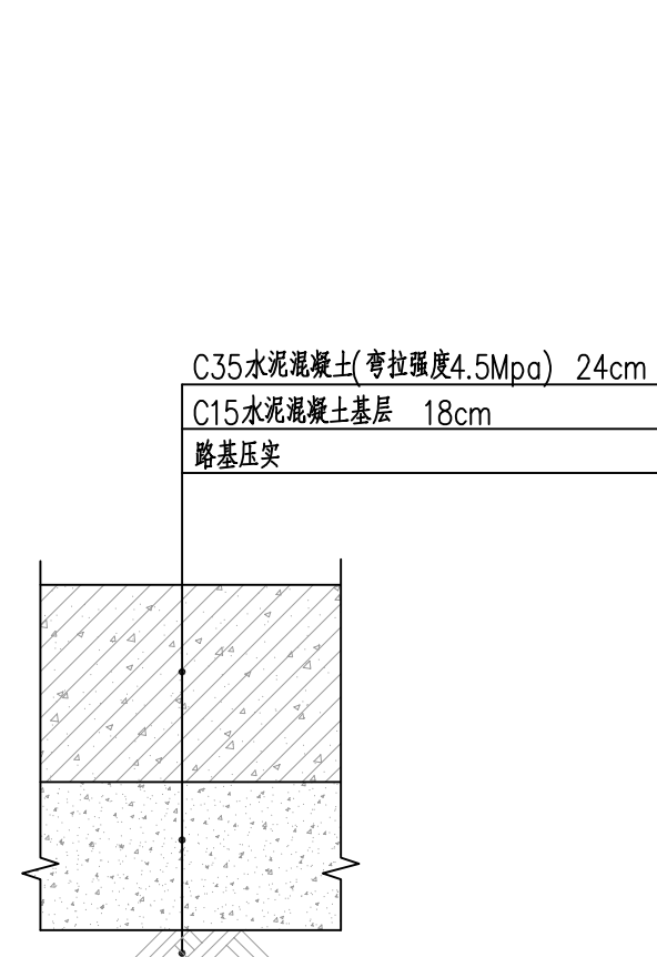
次干路、厂区道路混凝土路面恢复结构图
