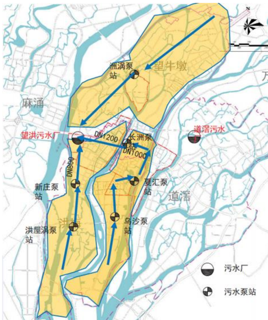
图 3.1-1 望牛墩-洪梅区域排水系统图
