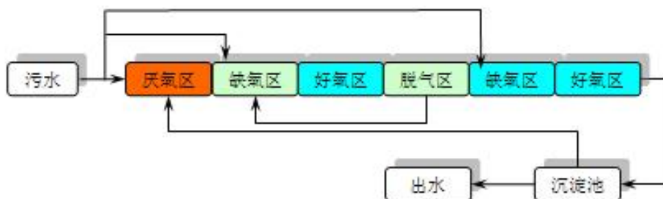
图 6.6-2 多段式 A 2 /O 模式工艺流程示意图
