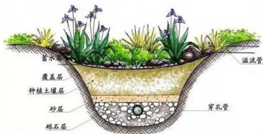
图6.11-5 生物滞留设施示意图
