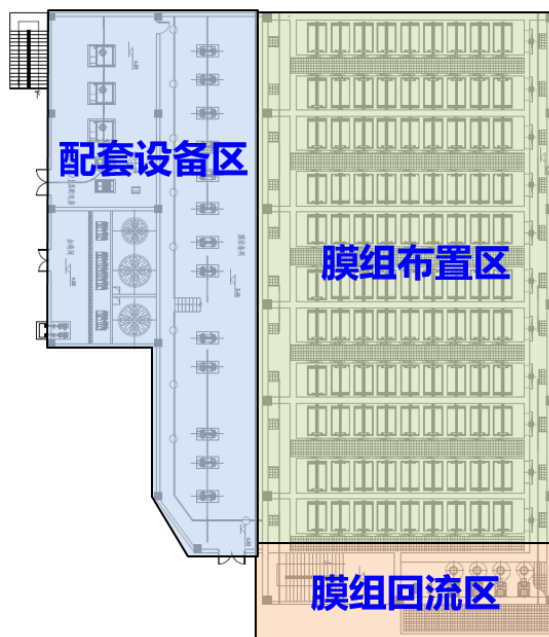
图5.7-24 新建 MBR 膜池布置方案
