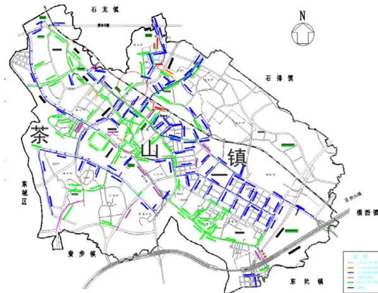
图2.3-3 茶山镇供水管网示意图
