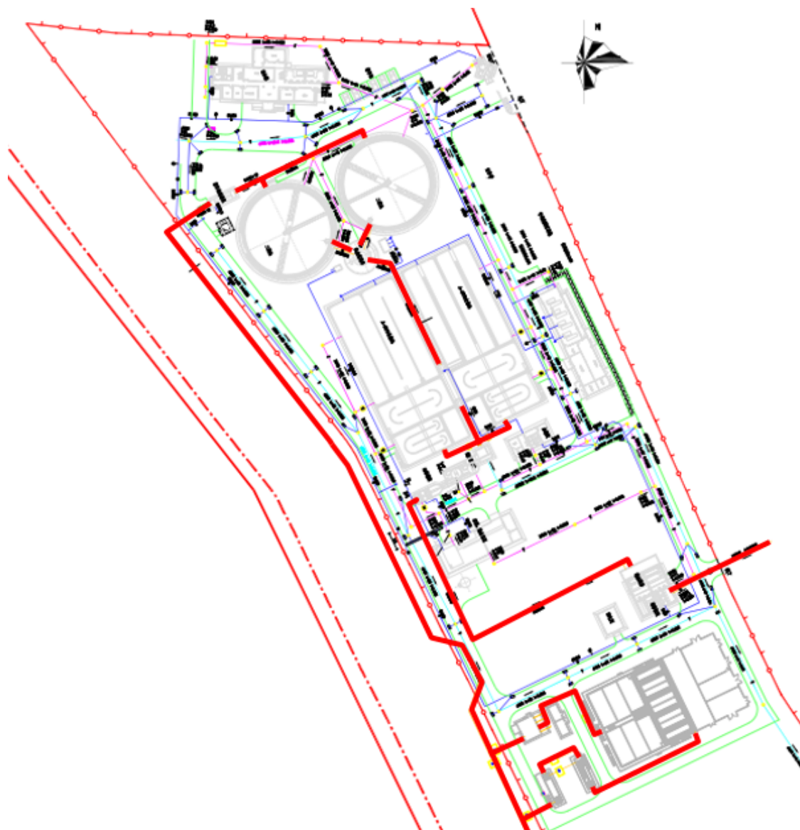
图6.5-1 茶山镇污水处理厂现状工艺管布置图
