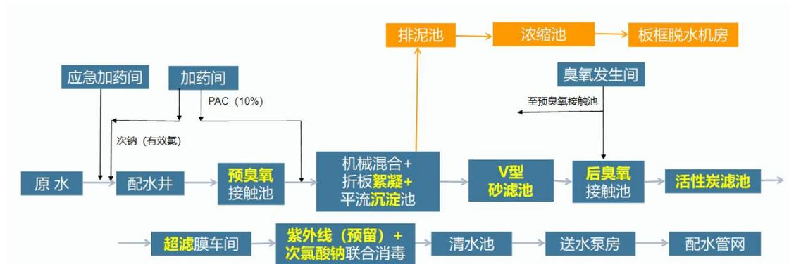
图 1 水线处理工艺流程
