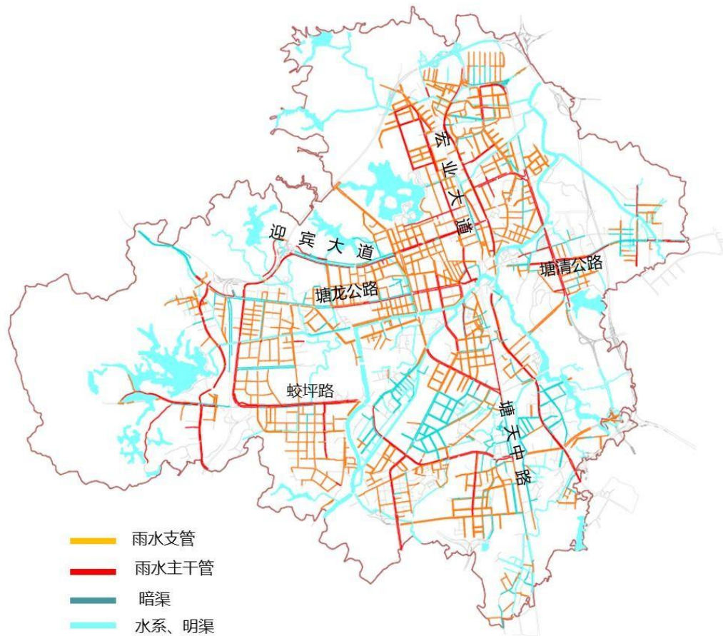
图 2.4.2-5 塘厦镇雨水管渠现状图
