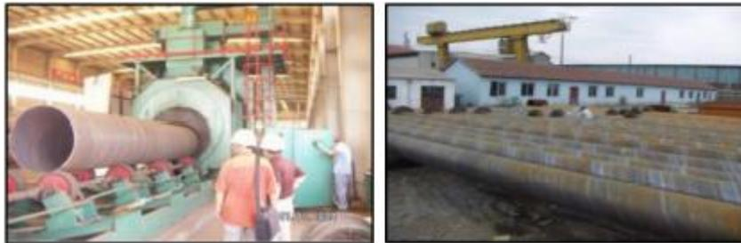
钢管工厂化加工表面除锈后钢管
