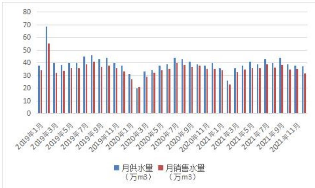
图 4.2-44 管网的月平均供、售水量统计图（桥头社区）
