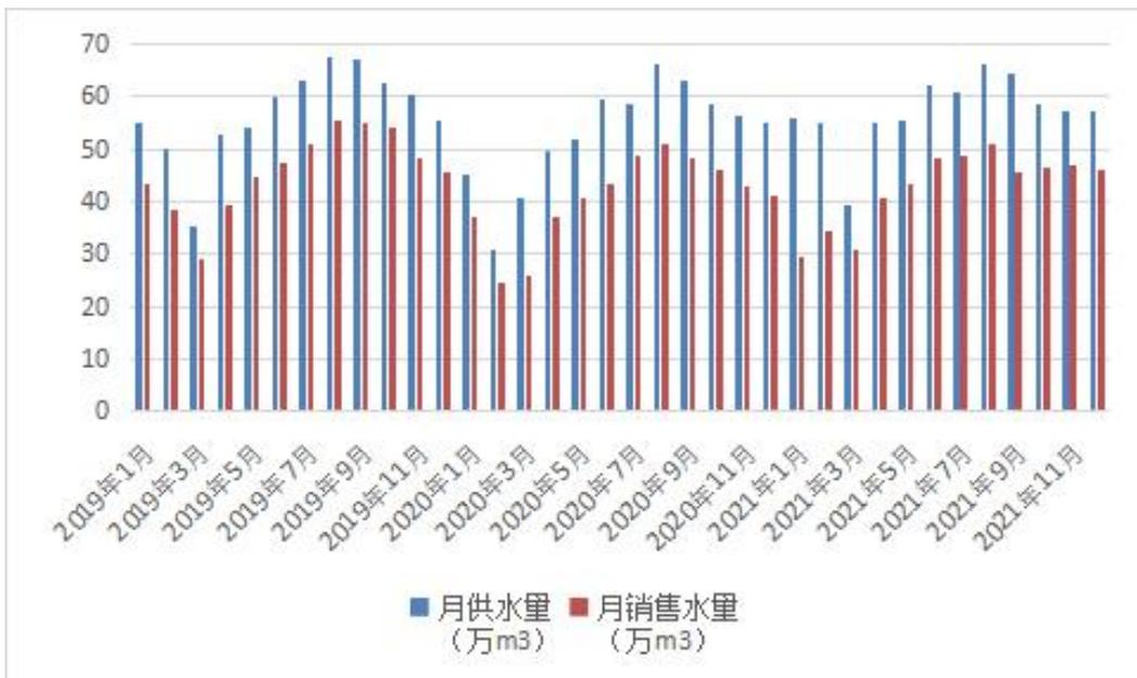
图 4.2-16 管网的月平均供、售水量统计图（三屯社区）
