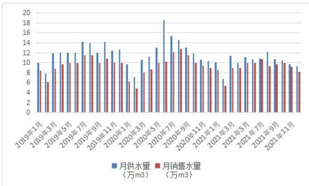
图 4.2-86 管网的月平均供、售水量统计图（宝塘社区）
