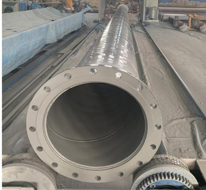
图 6.6-9 涂塑钢管实物图
