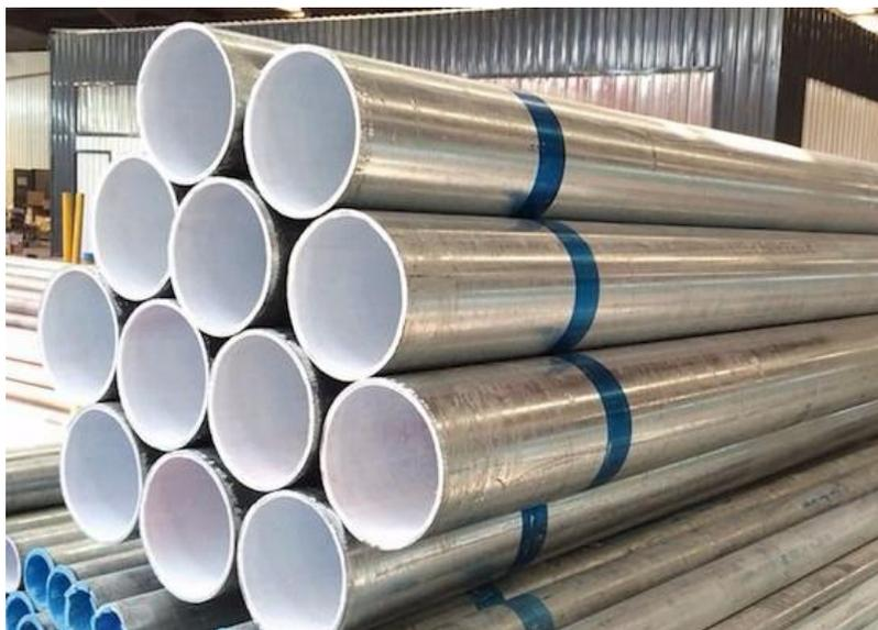
图 6.6-8 钢塑复合管实物图
