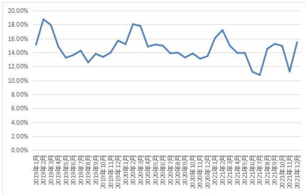
图 4.2-2 管网漏损率变化趋势图（厚街镇全镇）
