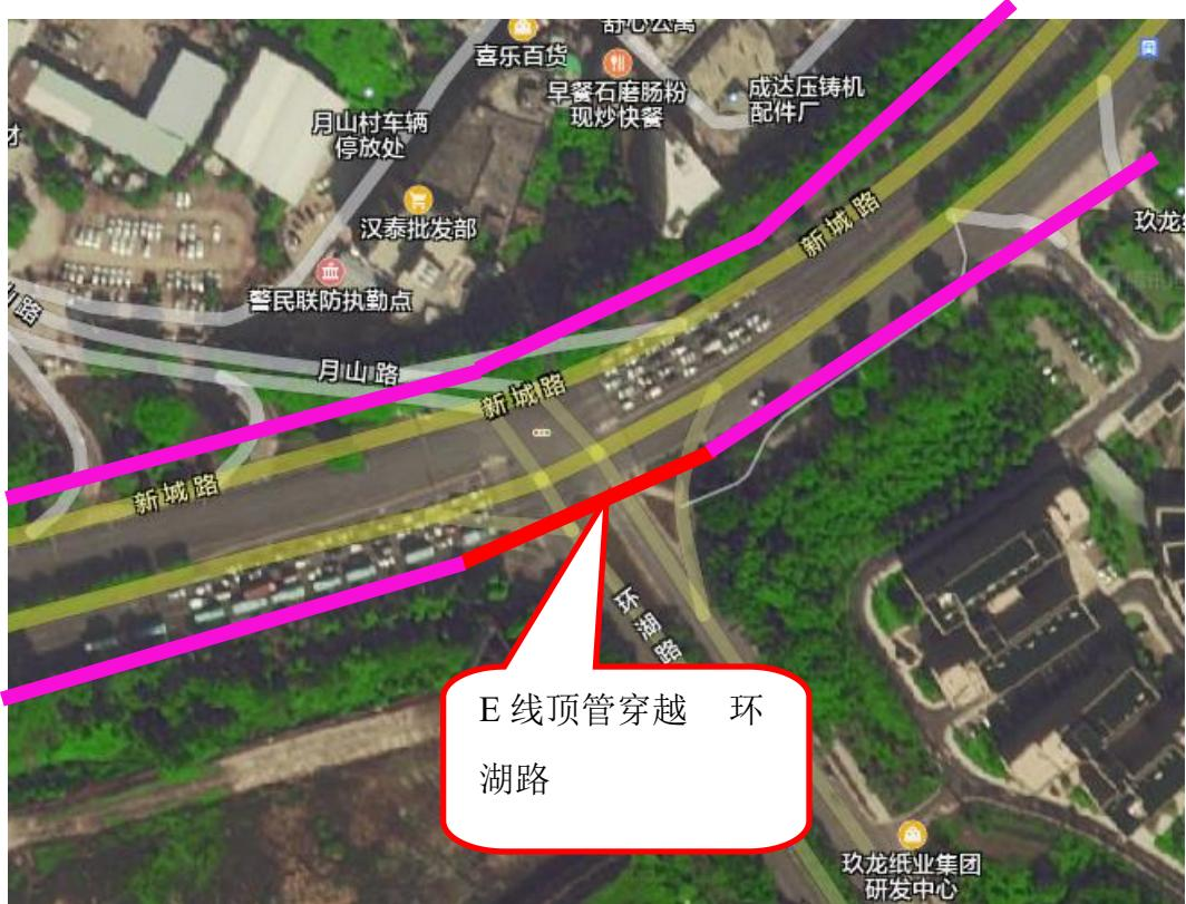
图 7-34 E 线顶管穿越环湖路平面示意图
