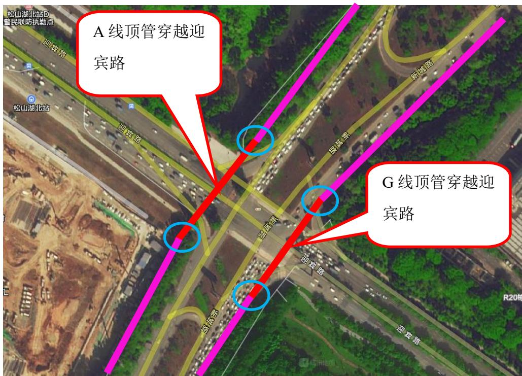
图 7-31 A 线和 G 线顶管穿越迎宾路平面示意图
