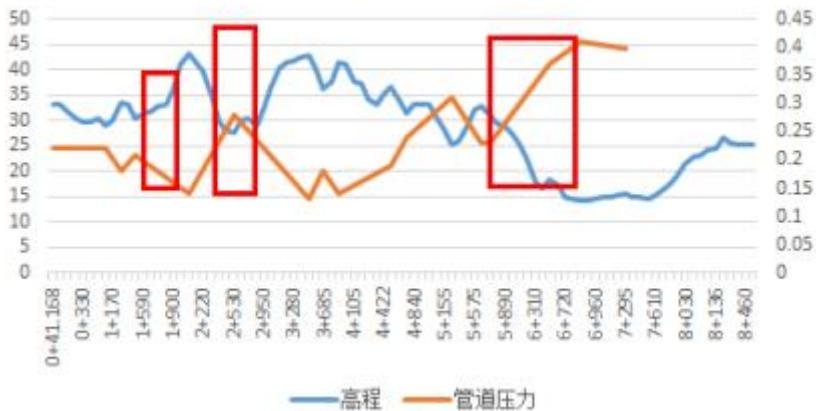
图 7-14 环湖路北线高程和管道压力差图（红框为爆漏频繁管段）
