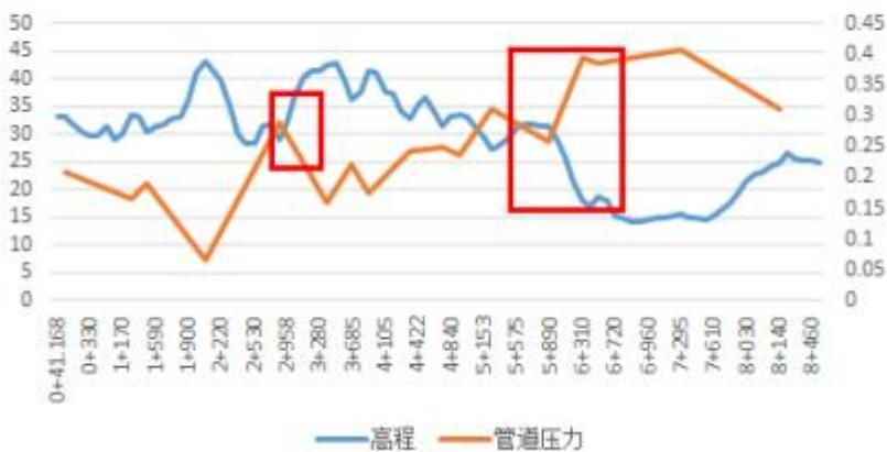
图 7-15 环湖路南线高程和管道压力差图（红框为爆漏频繁管段）
