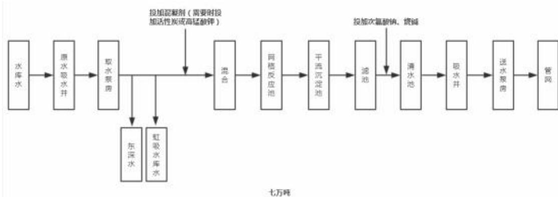
图 6-5 牛眠埔水厂生产工艺流程图
