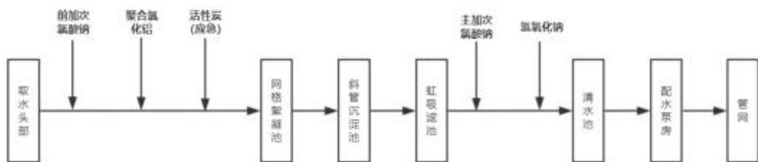
图 6-3 中心水厂生产工艺流程图
