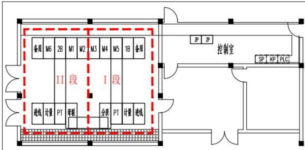
图 8-16 10kV 开关柜布置方案 1
