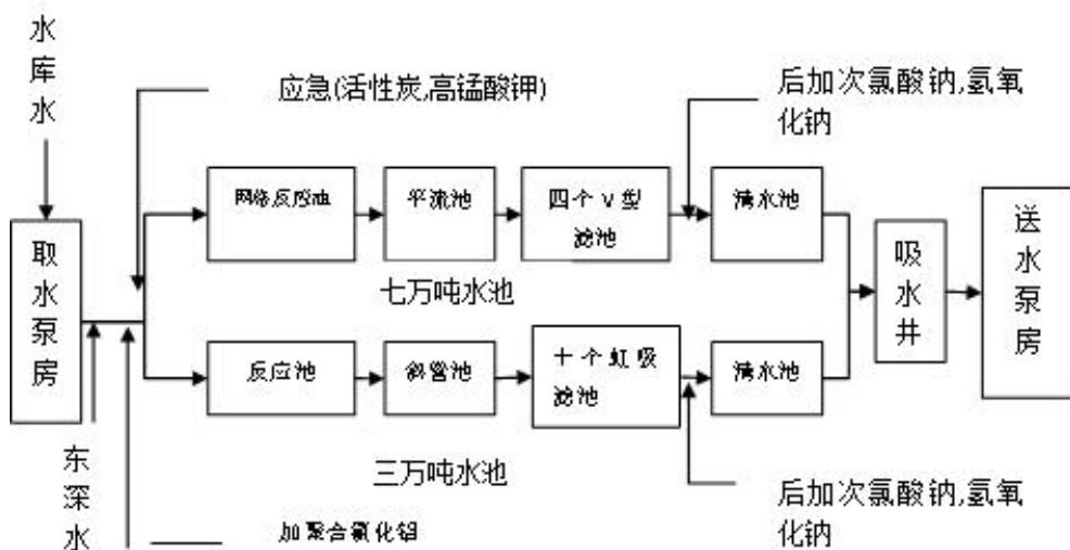
图 6-4 虾公岩水厂生产工艺流程图
