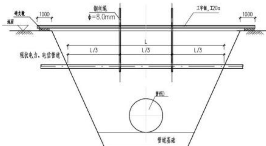
图 8-20 现状电力、电信管线保护大样图
