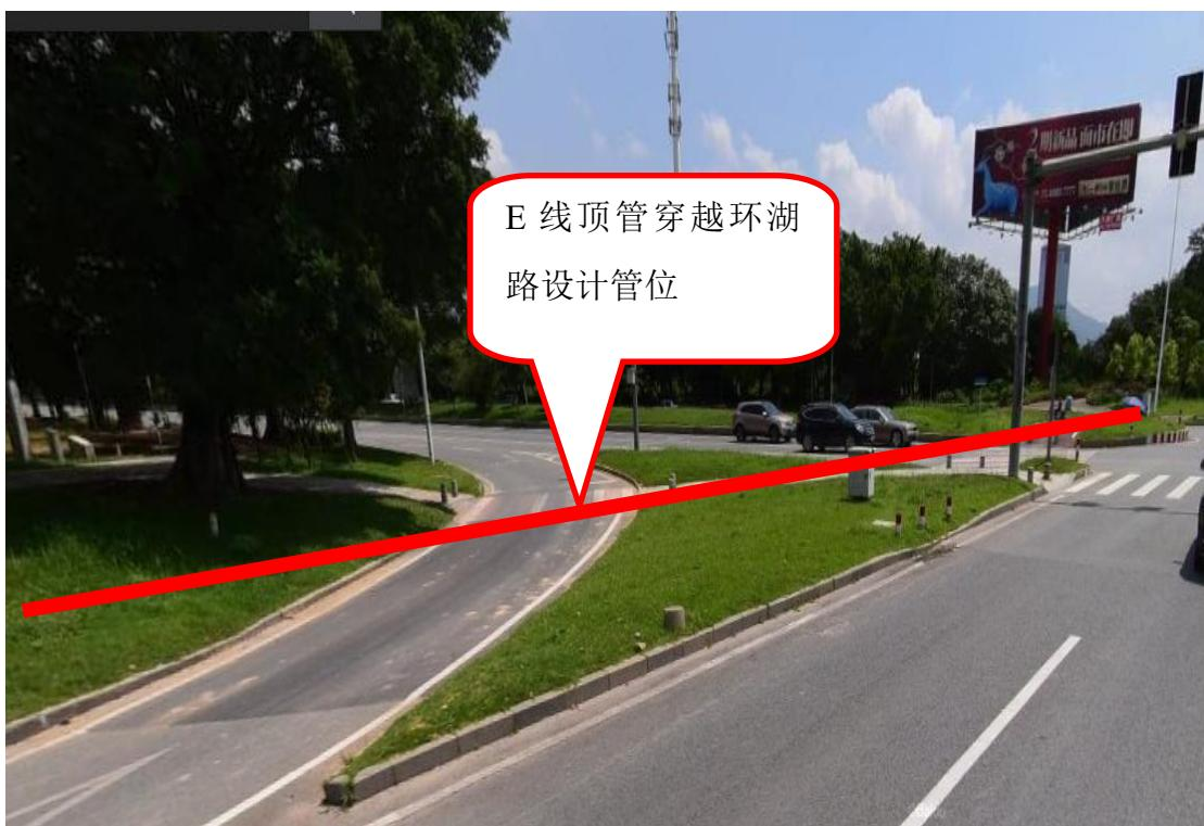
图 7-35 E 线顶管穿越环湖路路由示意图
