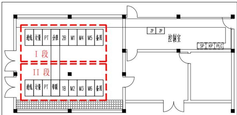
图 8-17 10kV 开关柜布置方案 2
