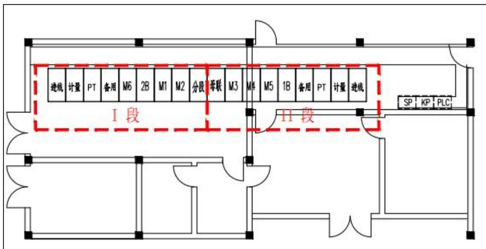
图 8-18 10kV 开关柜布置方案 3
