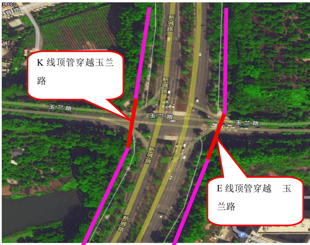
图 7-457 K 线和 E 线顶管穿越玉兰路平面示意图
