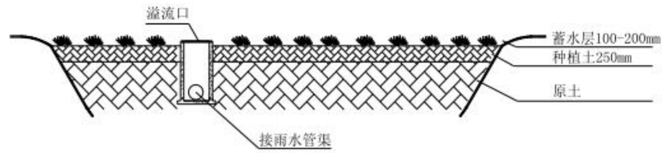
图10-3 下沉式绿地构造示意图
