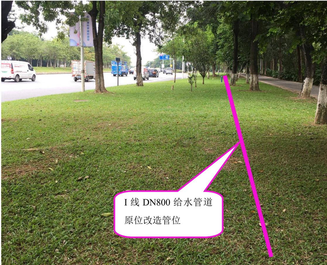
图 7-40 I 线管道路由示意图
