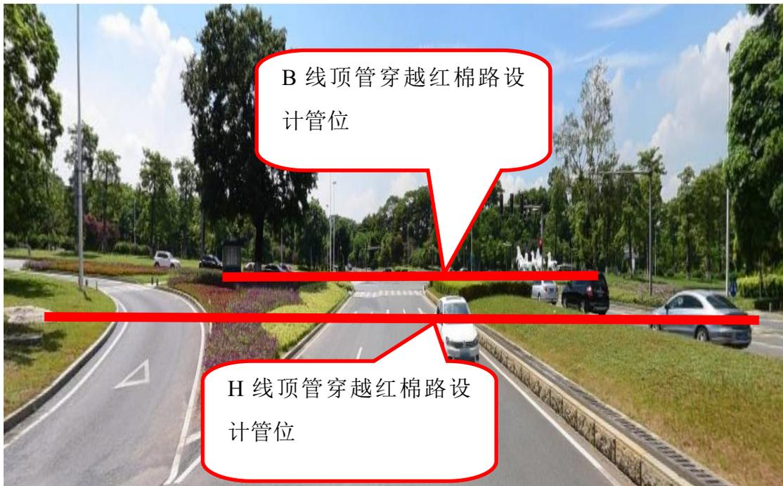
图 7-39 H 线和 B 线顶管穿越红棉路路由示意图
