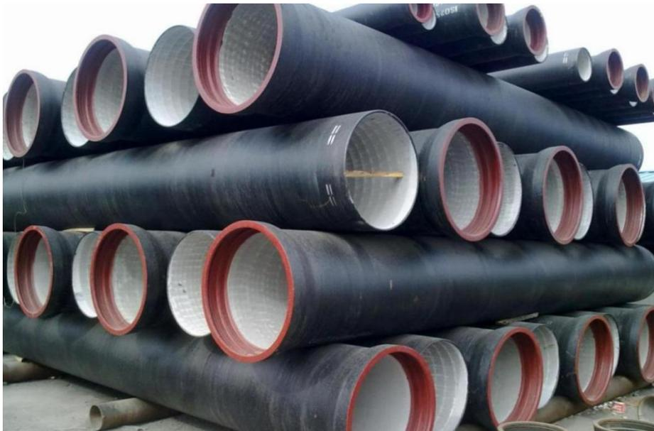
图 7-9 球墨铸铁管
