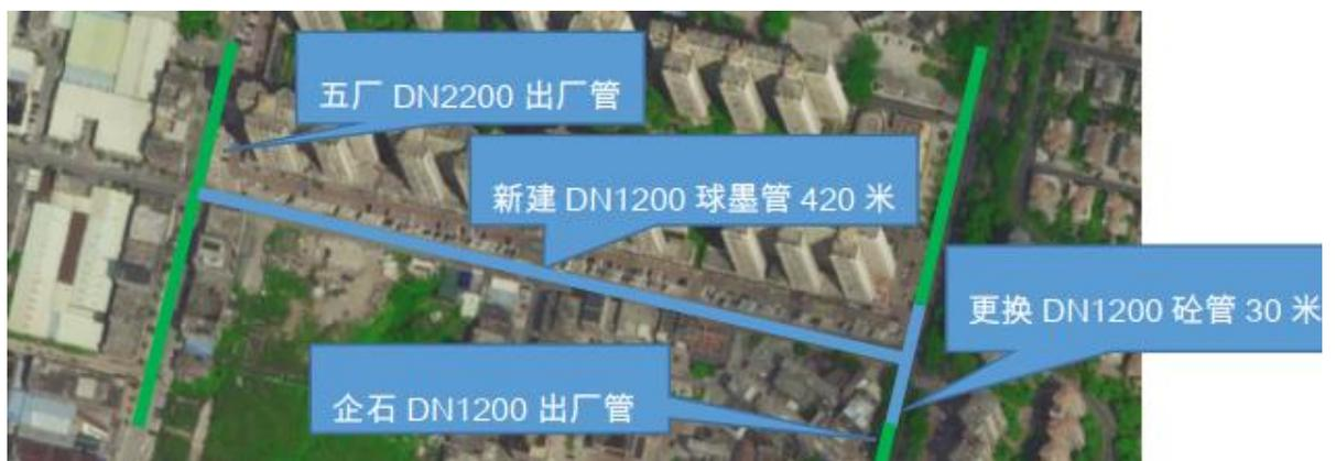
图 8-1 企石镇与市第五水厂供水管网连通工程方案设计图
