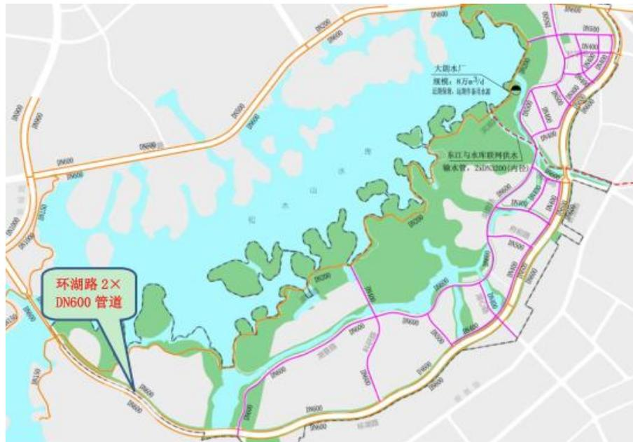
图 7-2 环湖路供水管网规划图
