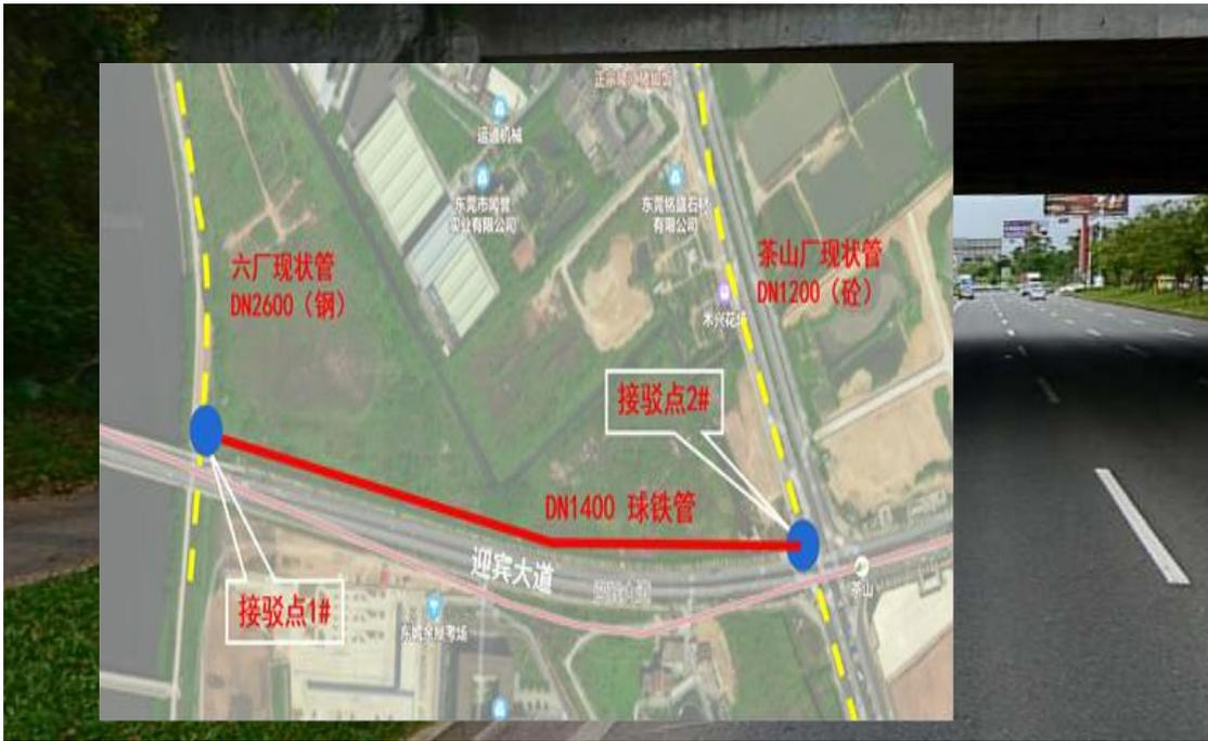
图 7-37 H 线顶管穿越珠三角环线高速路由示意图
