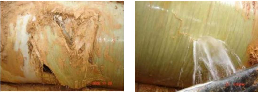
图 1-1 松山湖高新区管道自然爆漏照片
