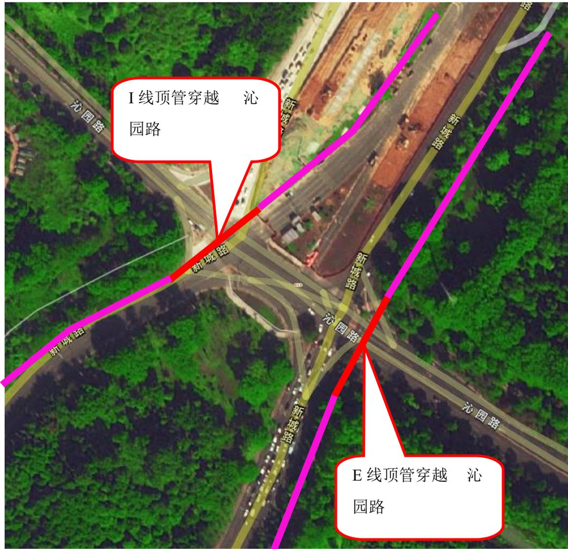
图 7-41 I 线和 E 线顶管穿越红棉路平面示意图
