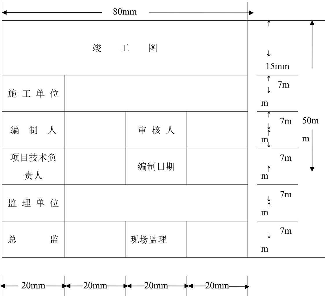
(三) 施工图涉及变更不大时，可利用施工图改绘成竣工图（变更内容需用碳素墨水
