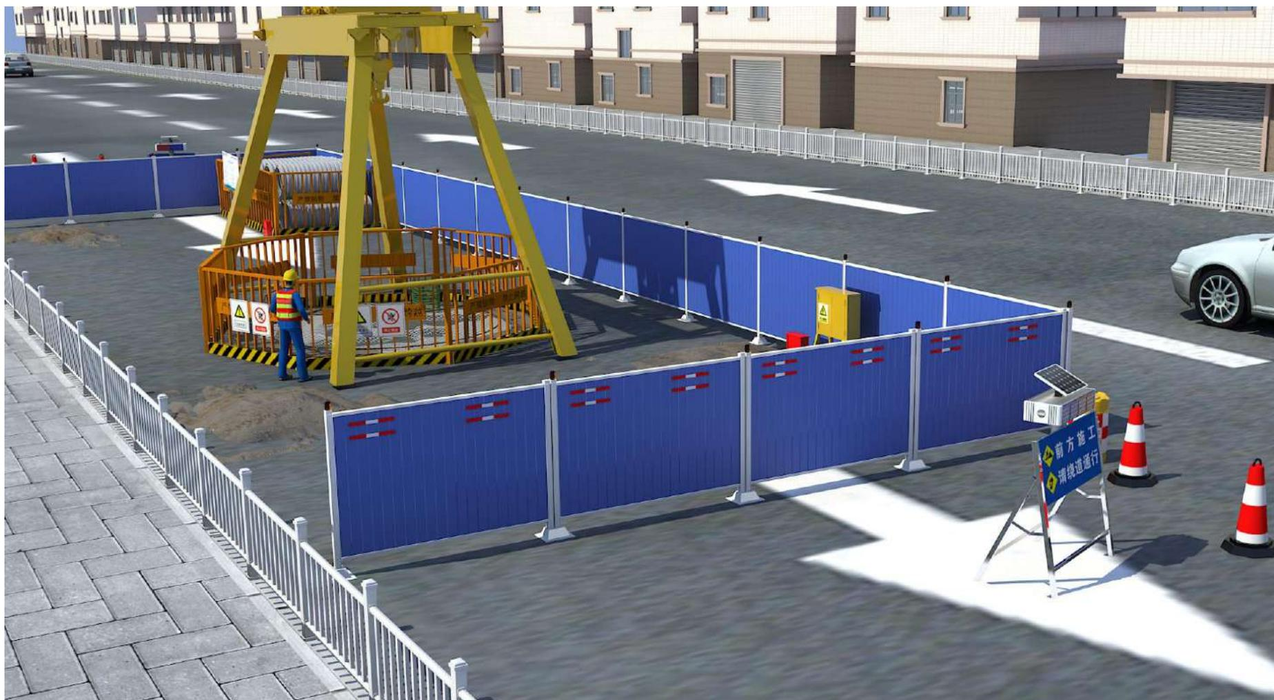
作业区域内部标准化（顶管施工）示意图
