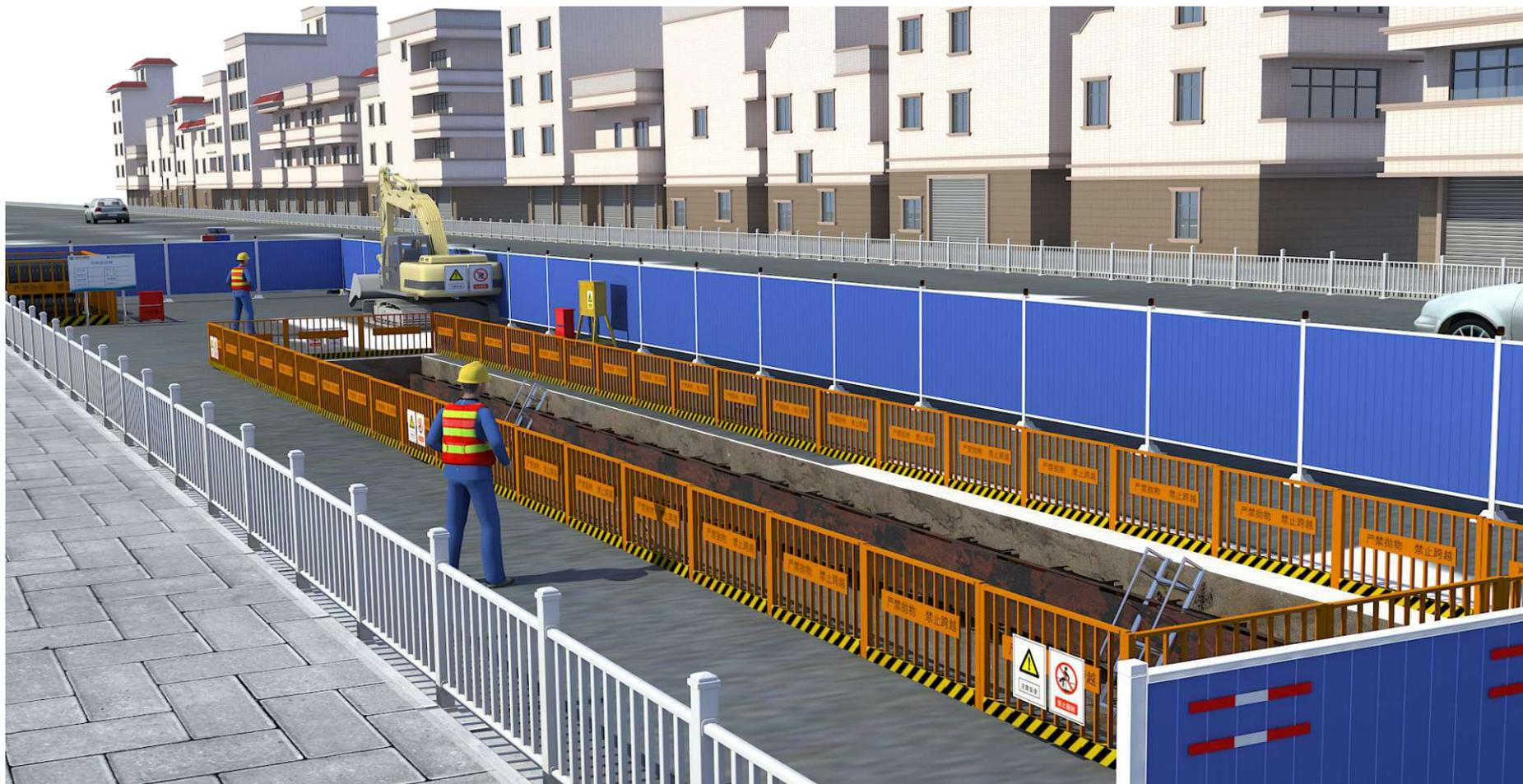
作业区域内部标准化（管道开挖施工）示意图（视角 1）
