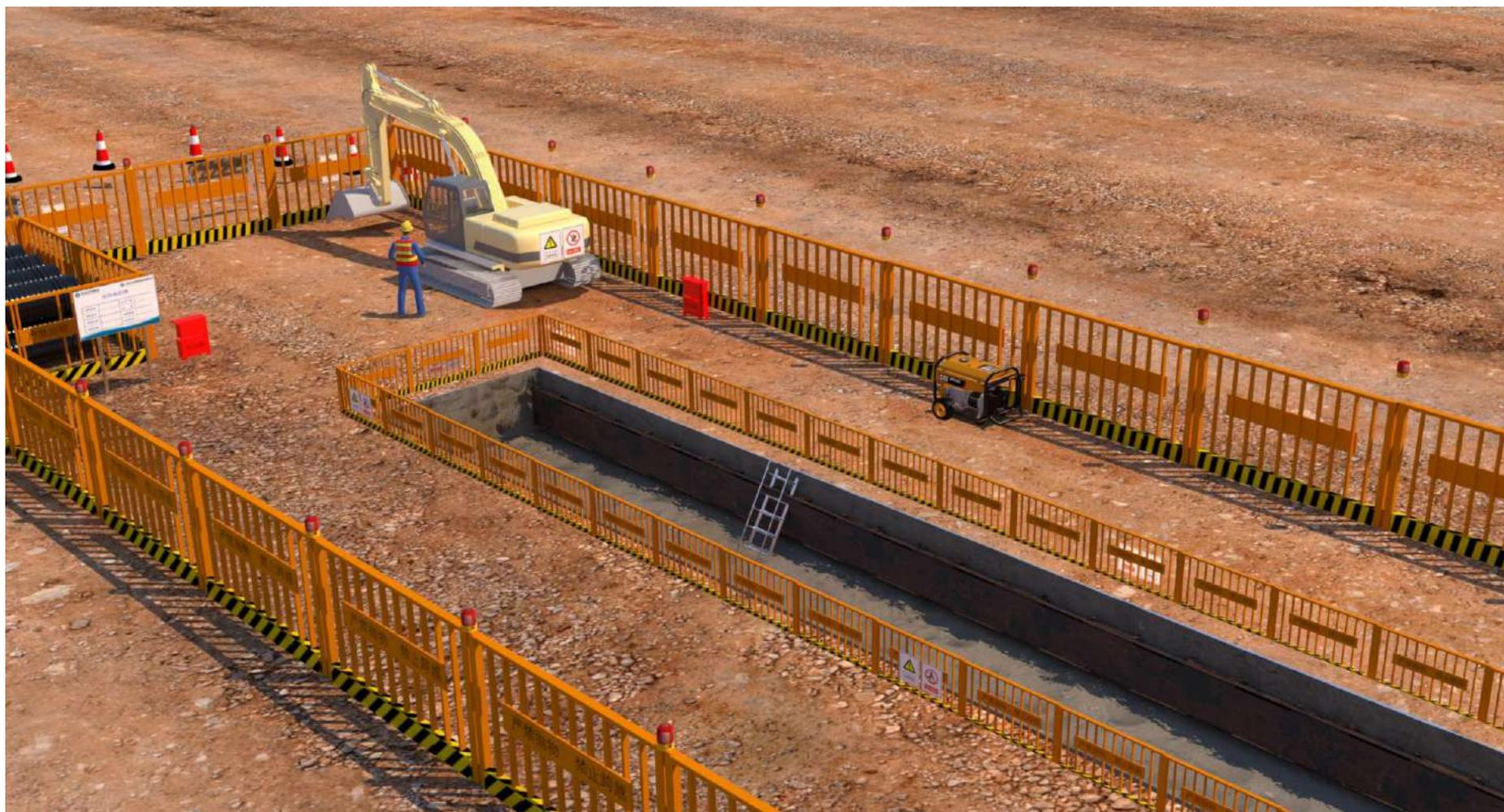
郊外管网维修工程（工期>1天）作业区域内部标准化（管道开挖施工）示意图
