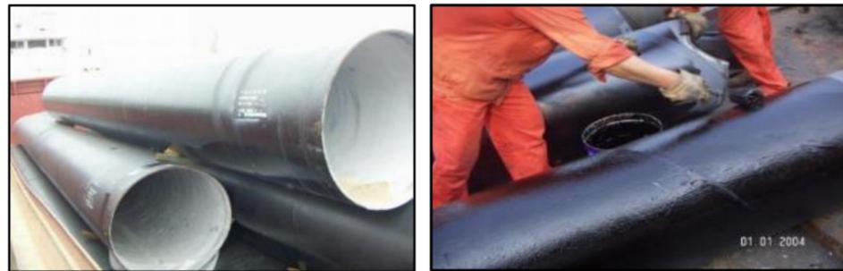
图5-2 钢管防腐处理
