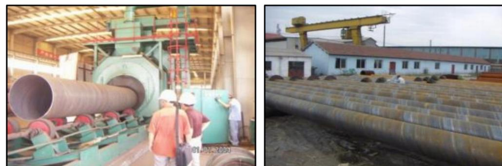
图5-1 钢管工厂化加工表面除锈后钢管
